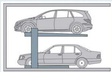
El modelo dispone de dos brazos hidráulicos de gran potencia y utiliza un motor monofásico de bajo consumo, que permiten acceder al vehículo estacionado en la parte superior en un tiempo máximo de 40 segundos.
