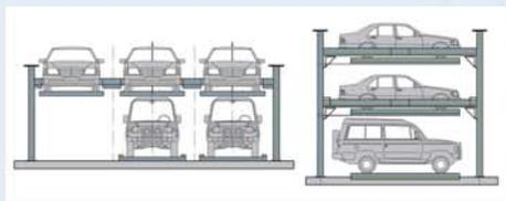
Para otorgar independencia al sistema, una de las columnas queda libre (excepto su plaza superior), permitiendo al resto desplazarse horizontal y verticalmente para hacer accesible la plataforma deseada. De esta forma cada vehículo puede ser retirado directamente sin necesidad de retirar ningún otro.
